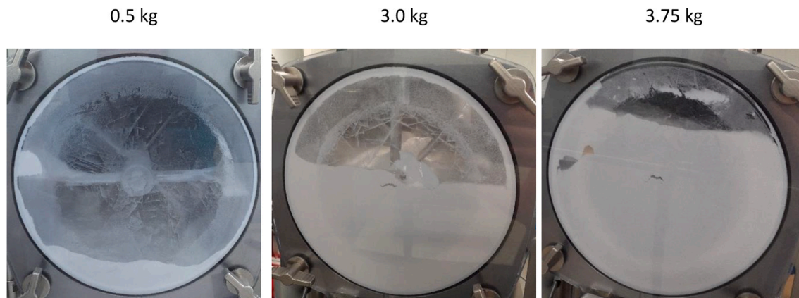
Fig. 11. Mini Blender fill level for 0.5 kg, 3.0 kg, and 3.75 kg blend mass.
